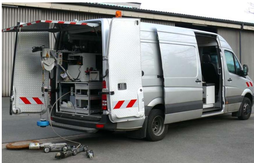
Abb. 4 - 7 Inspektionsfahrzeug und Inspektionskameras
