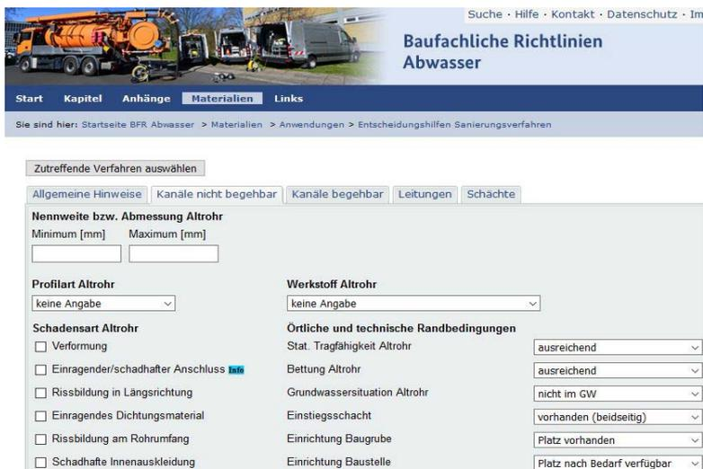
Abb. 4 - 12 Auswahl von Sanierungsverfahren
